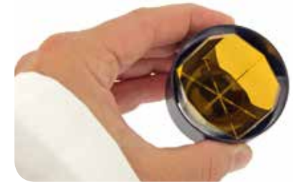
MPA的核心——RockSolid专利干涉仪采用了入射光与出射光平行的三维立体角镜技术，增强了抗振性能。
